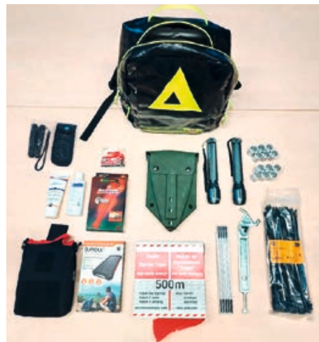
Das umfassende Equipment, das ein Deichläuferteam (immer zwei Beschäftigte) dabei haben muss
